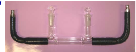
Cellules de conductivité de fluide à électrodes de platine noircies au platine, construites par Paul Glover pour mesurer la conductivité des fluides en fonction de la fréquence avec une grande précision.
