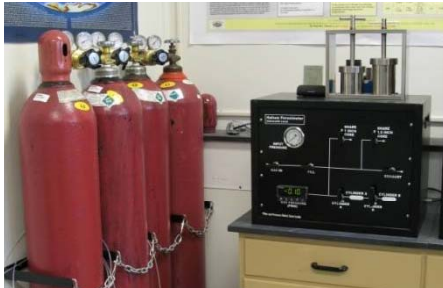
Le nouveau porosimètre à Hélium pour des échantillons cylindriques de 1 ou 1.5 pouces de diamètres.
