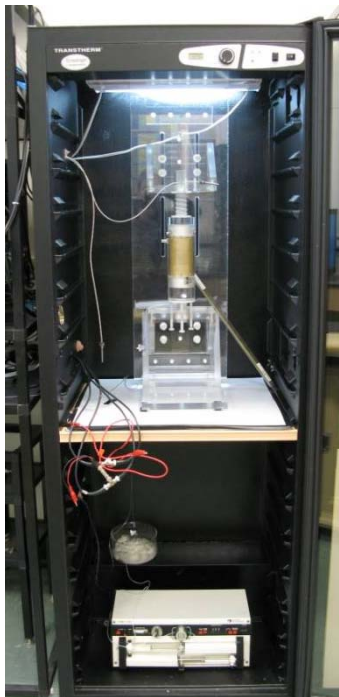
La cellule de spectroscopie d'impédance à faible pression installée dans une chambre à température contrôlée, construite à partir d'un cellier à vin.
